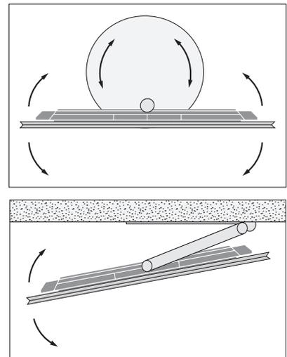
*Il processo di calibrazione consente di impostare l'angolo di rotazione massimo del televisore, a sinistra e a destra.*
