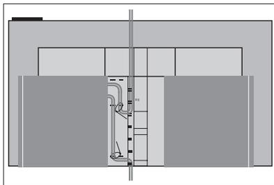
Se si possiede uno stand o una staffa da parete motorizzati, assicurarsi che i cavi siano sufficientemente lunghi da consentire la rotazione o l'inclinazione del televisore prima di avvolgerli in un unico fascio, con i fermacavo.
